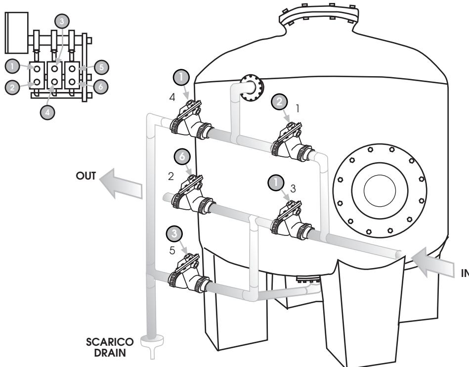
**2 Filtro singolo (controlavaggio + risciacquo rapido) con 5 valvole idropneumatiche Normalmente Chiuse e timer 3 piloti.**
